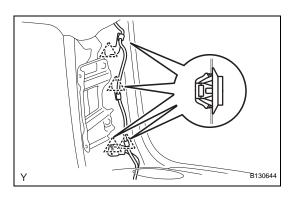
(d) Using a clip remover, remove the 3 clamps and the connector.
